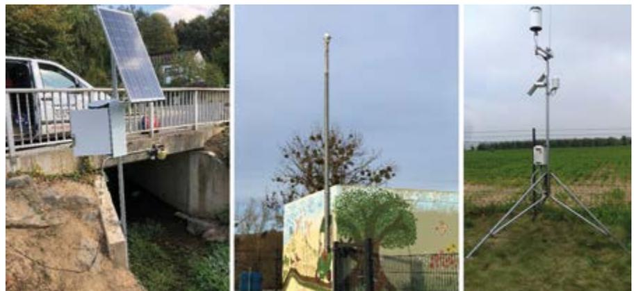
Abbildung 7: Sensorik zur Pegel- und Fließgeschwindigkeitsmessungen inkl. Solarmodul, Niederschlagssensoren.
