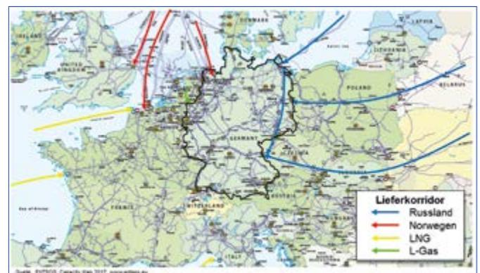
Abbildung 2: Importrouten von Erdgas nach Deutschland. (Quelle: ENTSG Capacity Map 2017, www.entsg.eu)
